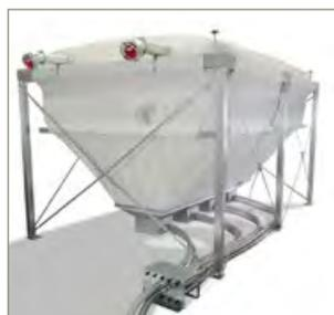
Abb. 9b: Konussilo in Modulbauweise
