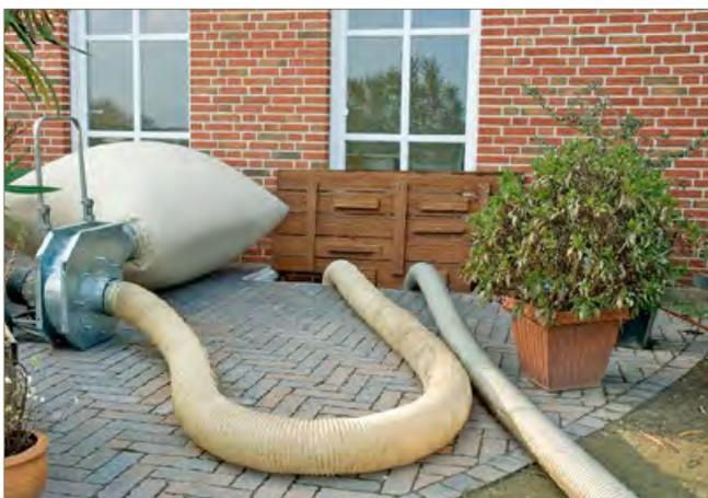
Abb. 4: Absaugventilator mit Staubsack
