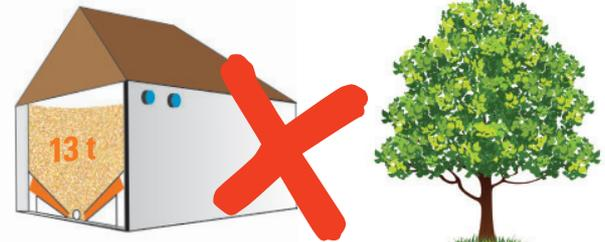
FALSCH: Einblas- und Absaugstutzen führen zwar mit zwei belüftenden Verschlussdeckeln ins Freie, aber das Fassungsvermögen des Lagers ist > 10 t. Wenn die Belüftung über die Deckel erfolgen soll, muss mind. eine weitere Öffnung mit belüftendem Deckel geschaffen werden. 4 cm<sup>2</sup>/t notwendiger freier Belüftungsquerschnitt (je Deckel 20 cm<sup>2</sup>) Belüftung über die Deckel bis Fassungsvermögen 40 t ist möglich.
