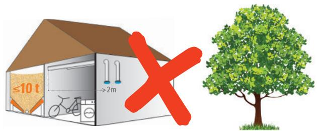
FALSCH: Einblas- und Absaugstutzen führen ins Freie. Auf beiden ist ein belüftender Deckel angebracht. Allerdings sind die Leitungen zwischen Lager und Kupplung länger als 2 Meter. Dadurch ist die Belüftung nur eingeschränkt wirksam. Es sollten separate Lüftungsöffnungen oder eine technische Belüftung gekoppelt mit der Zugangstür geschaffen werden.
