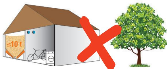
FALSCH: Auf beiden Stutzen ist zwar ein belüftender Deckel angebracht. Einblas- und Absaugstutzen führen aber nicht ins Freie oder in einen ausreichend belüfteten Raum (Heizraum mit Verbrennungsluftöffnung), sondern in einen Nebenraum. In dieser Situation dürfen nur verschlossene Deckel angebracht werden! Die Belüftungsöffnung nach draußen muss über eine separate Öffnung geschaffen werden.
